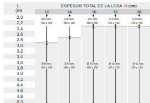
Armaduras de reparto y en condiciones mínimas.
